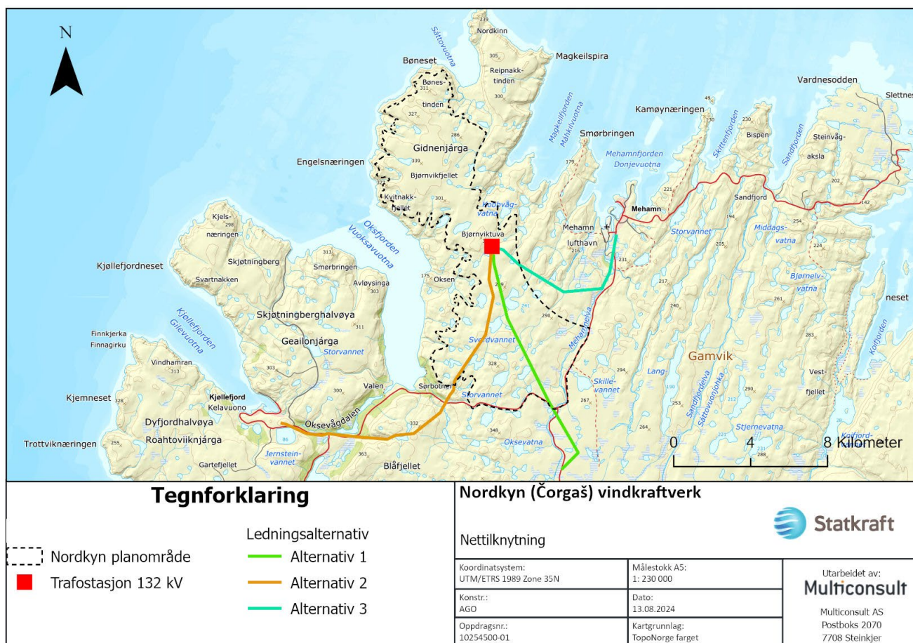
Figur 2-3: Oversikt over meldte alternativer for nettilknytning knyttet til planområdet til Nordkyn vindkraftverk.
